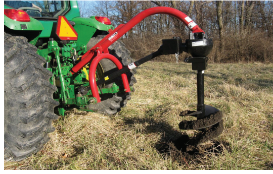
حفار يعمل بقوة الجرار
