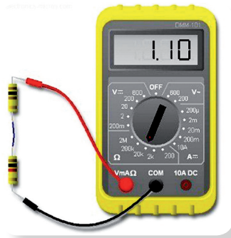
الشكل (٢) قياس المقاومة بجهاز المالتيميتر
